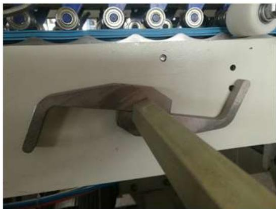
Portiunea de pliere a colturilor (4 si 6) este una mecanica in concordanta cu sistemul fotoelectric, lucru care asigura inchiderea cutiilor intr-un mod rapid si stabil.
