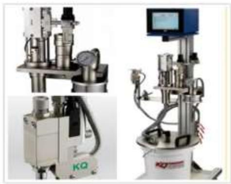
Sistemul de sprayere (la rece pe baza de apa), este necesar pentru cutiile neregulate, are incorporate 3 pistoale, este convenabil in productia diferitelor cutii speciale.
