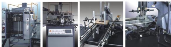
黏角 Former 液压纠偏装置 Spotter 定位黏合部 Spotter 纸盒成型 Wrapper
