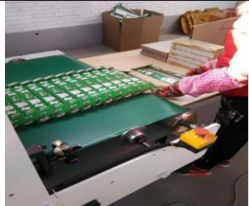
Cutiile sunt pliate de rolele de presare si numerotate de sistemul fotoelectric, astfel asigurand o viteza sporita.
